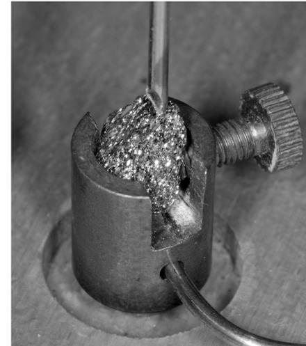
Ferdinand Braun: „Über die Stromleitung durch Schwefelmetalle“, eingereicht bei [Annalen der Physik und Chemie](#) am 23 November 1874. Beobachtung, dass der elektrische Widerstand verschiedener natürlicher und künstlicher Schwefelsulfide von der der Richtung, der Intensität und der Dauer des elektrischen Stromes abhängig ist.
